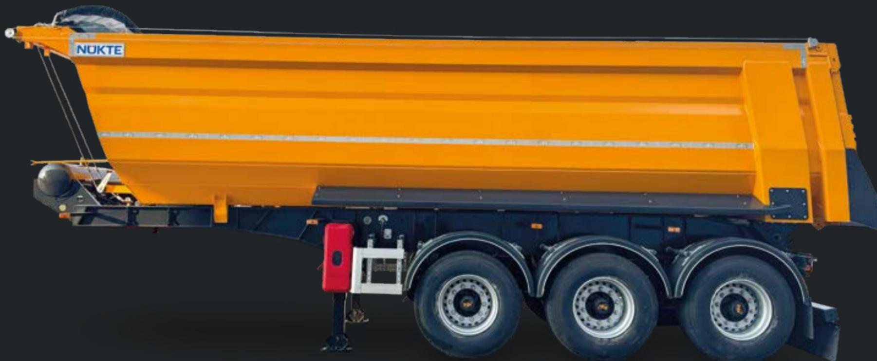
**ТОРМОЗНАЯ СИСТЕМА:** Двухконтурная тормозная система, соответствующая нормам ECE R13. Система WABCO RSS с электронной антиблокировочной системой 2S/2M. Аварийный останов и клапан ramпы.
